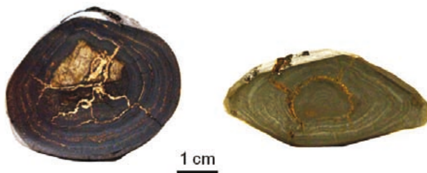
Figura 1. Sección transversal pulida de dos nódulos colectados en la Campaña MIMAR VI. El núcleo es un fragmento de roca volcánica de forma triangular (izquierda) y núcleo de un nódulo antiguo (derecha).
